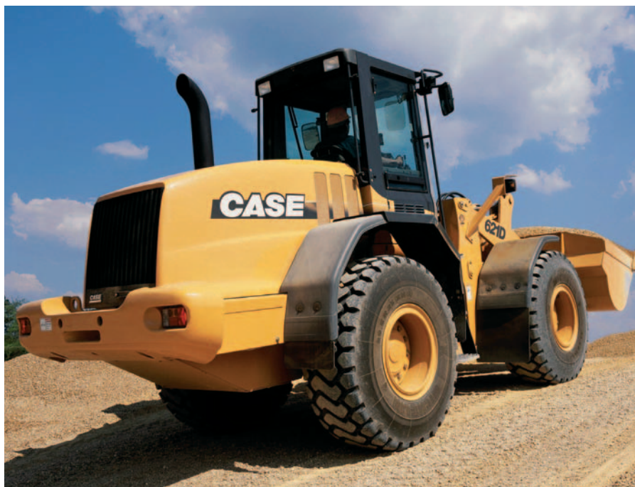
Motorul încărcătorului Case 621D dezvoltă o putere de 150 CP
